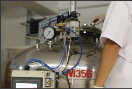
Pressure Test Tank (EN 60529 IP Test)
