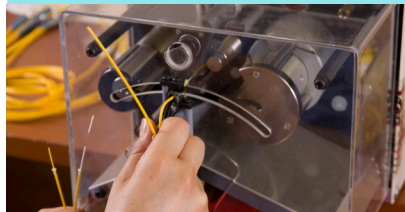
Kevlar Schneiden mit Vakuumpumpe
