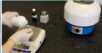
Messung von Epoxy Menge
