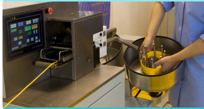
Coupage du câble et d'enroulement
