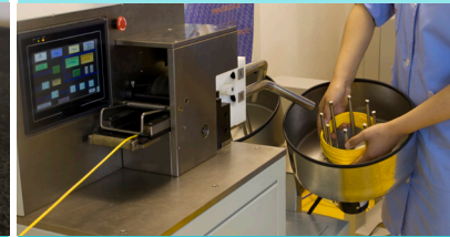
Резка и обмотка кабеля
