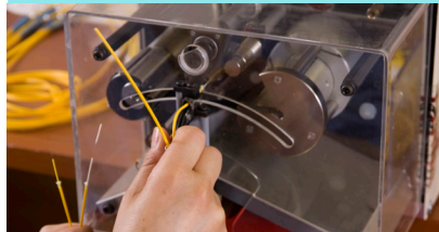
Нарезка кевларового волокна с помощью вакуумного насоса
